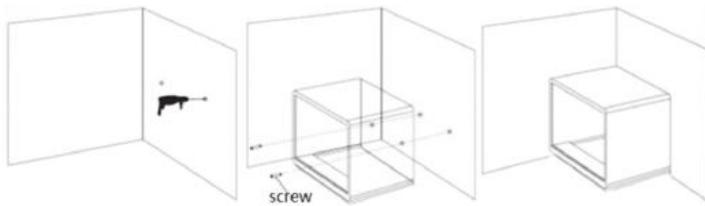
Étape 1 : Veuillez percer des trous pour les boulons d'expansion au bon endroit
